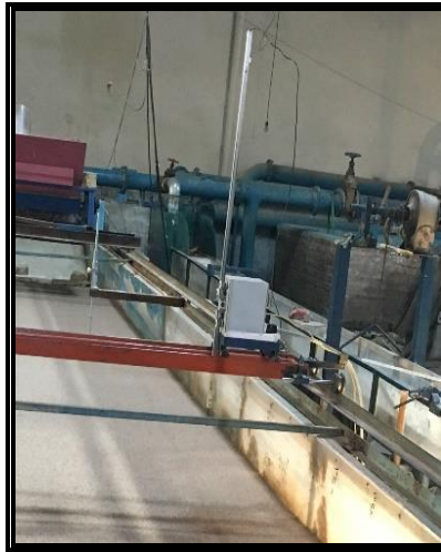
شکل ۲- دستگاه بسترسنج استفاده شده در آزمایش‌ها
