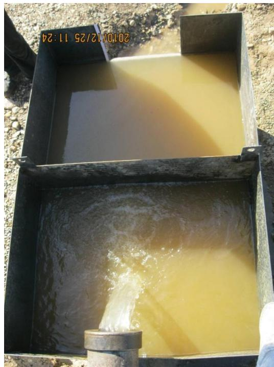
شکل ۳- روش اندازه‌گیری دبی پمپاژ با استفاده از سریز مستطیلی
